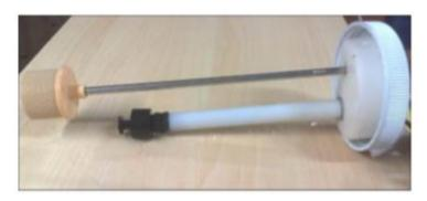
Figura 8 Sensor de Nível para Água DI
